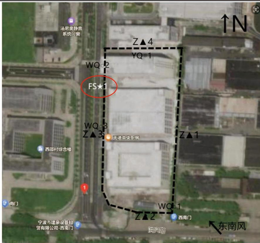
◎-有组织废气采样点；○-无组织废气采样点；★-废水采样点；▲-噪声检测点
