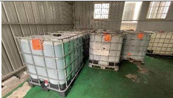
废槽液采用吨桶存放
